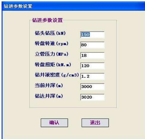
图 2-5-1 钻进模拟参数的设置
