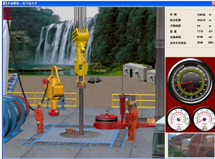
图 2-3-9 起下钻发生井涌时的关井程序虚拟仿真
