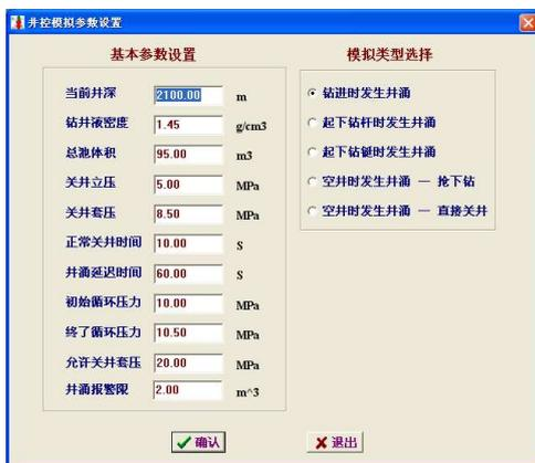
图 2-5-3 井控模拟参数设置
