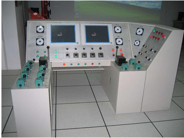
图 2-4-2 盘刹司钻控制台
